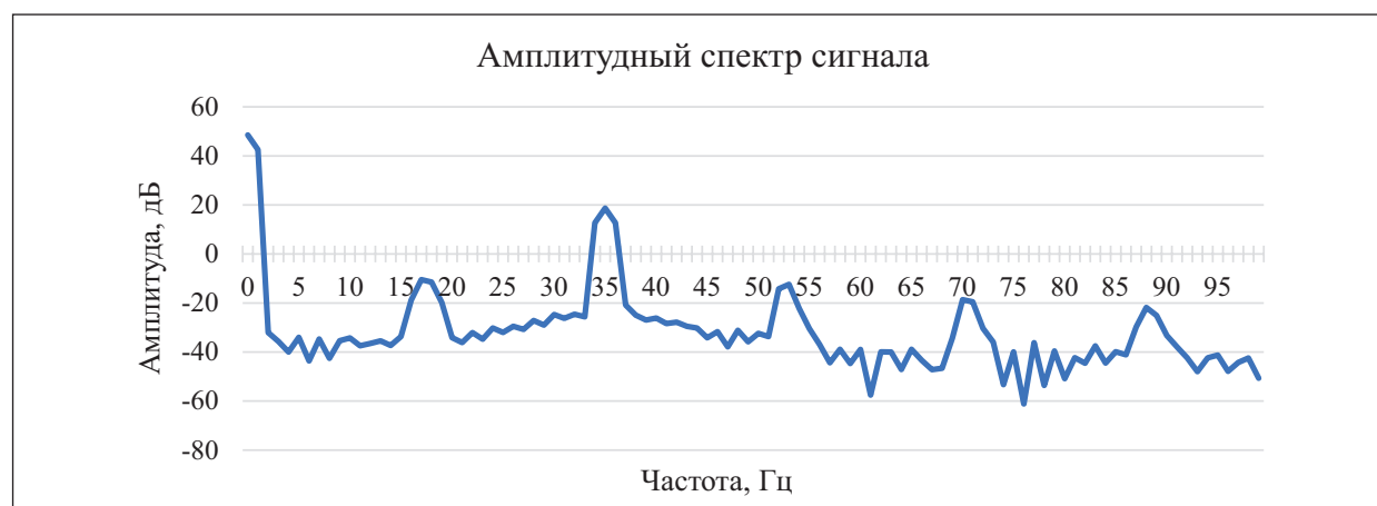
Рис. 5. Амплитудный спектр измеренного сигнала с максимумом на частоте 35 Гц
