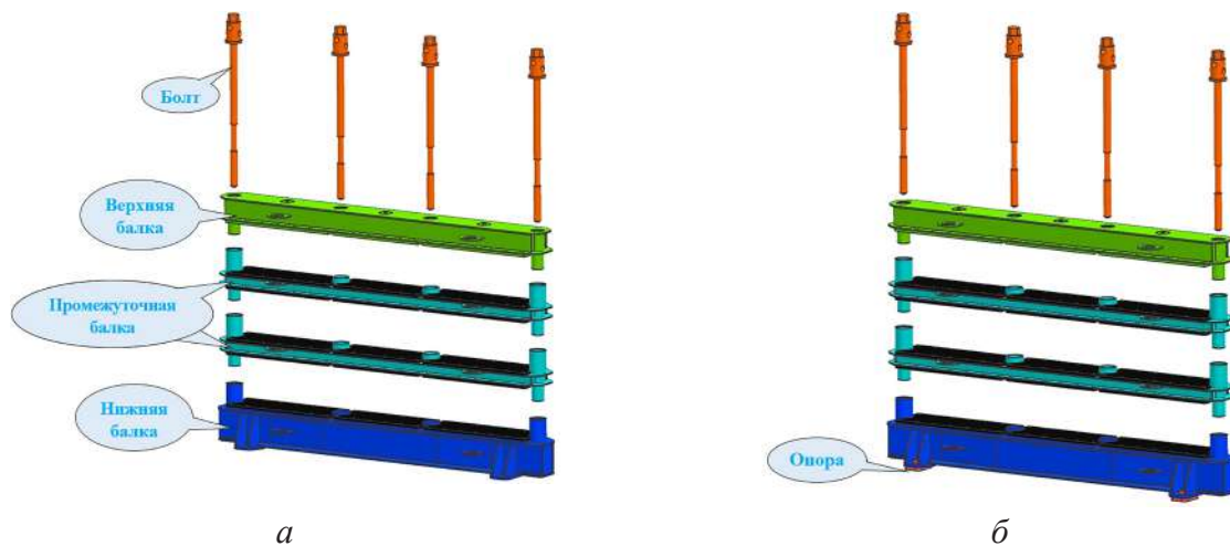
Рис. 2. Состав секции МКК: a — промежуточная секция, б — концевая секция
