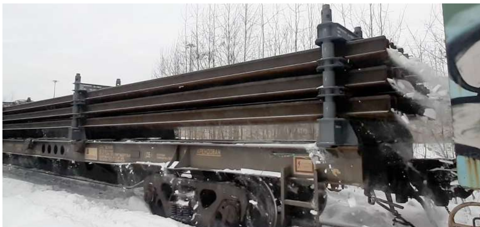
Рис. 9. Соударение платформы с испытуемым МКК и рельсами при испытаниях проверки надежности размещения и крепления груза
