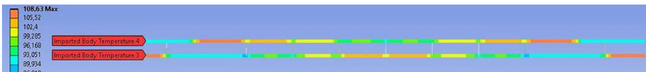
Рис. 5. Результаты электротеплового расчета проводов КС
