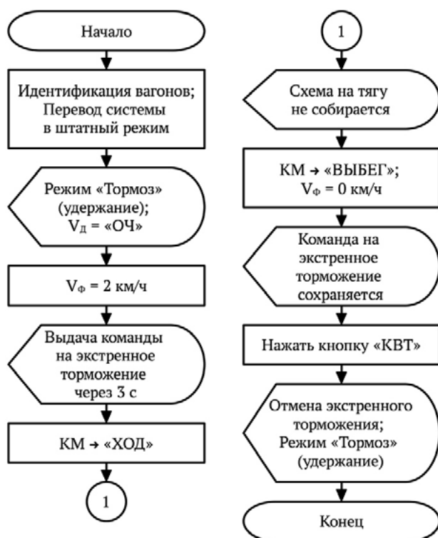
Рис. 4. Блок-схема алгоритма, описывающая процесс проверки функционирования комплекта поездных устройств АЛС-АРС при ОЧ и ненулевой скорости
