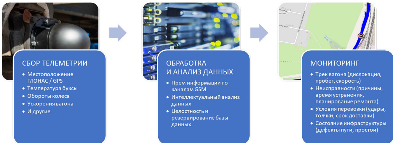
Рис. 2. Общий алгоритм работы УМДВ (фото — А. А. Шамрай)
