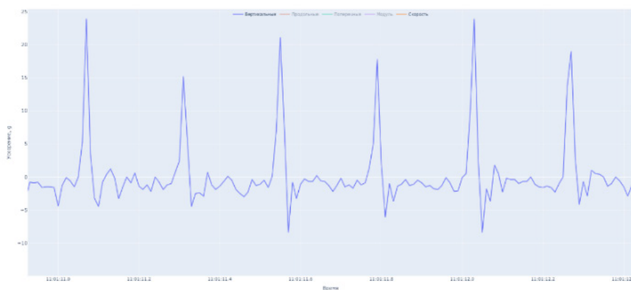
Рис. 14. УМДВ № 0017, груженный вагон, 0,8 мм ползун, скорость 60 км/ч
