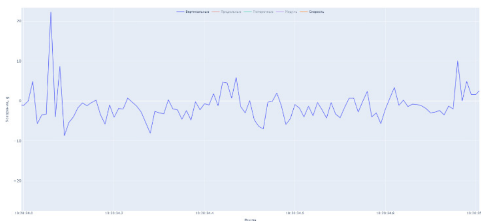
Рис. 16. УМДВ № 0012, грузеный вагон, скорость 60 км/ч, ползун на колесе с УМДВ № 0017
