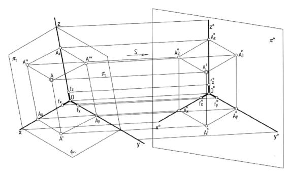
Рис. 5. Теоретическая модель аксонометрического проецирования
