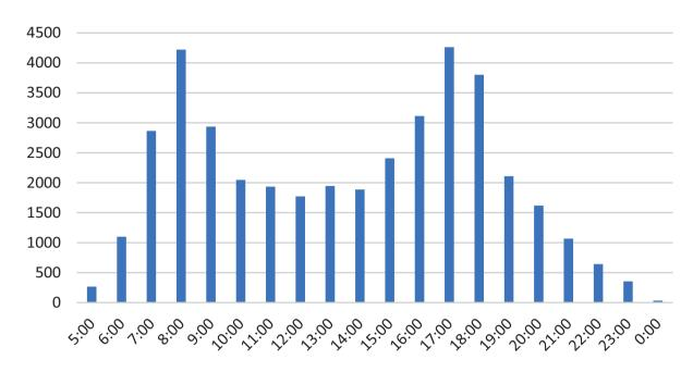
Рис. 9. Графическое отображение максимального входного пассажиропотока на перегоне «Ст. Ладожский вокзал — Пр. Наставников» во времени
