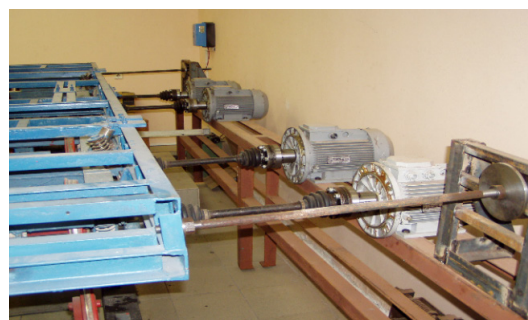
Рис. 3. Конструкция стенда: а — привод катков, моделирующих колесные пары локомотива; б — карданная передача привода катков
